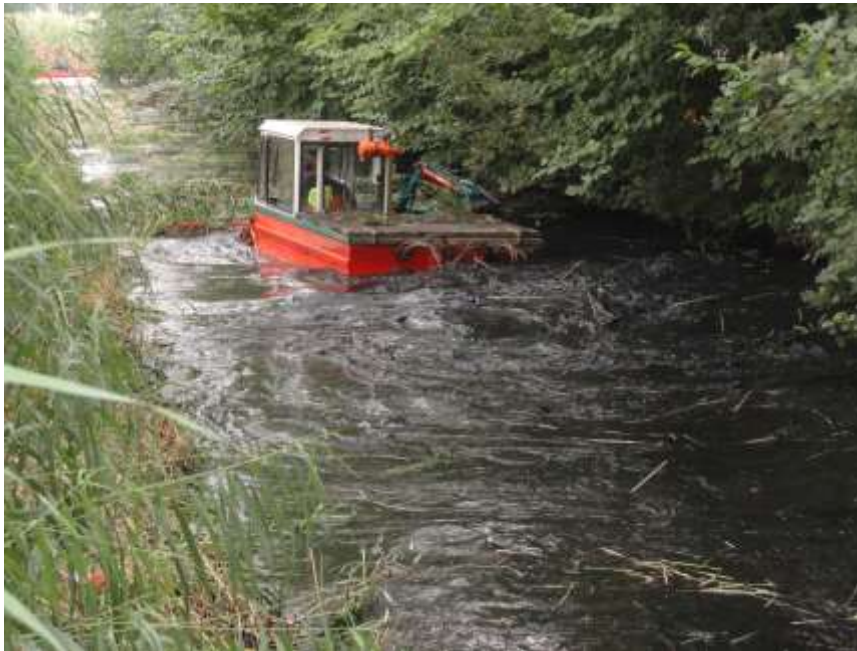
Figuur 6.2 Maaien met de maaiboot heeft een grote impact op het water door sterke omwoeling van de baggerlaag en het achterblijven van veel maaisel. Hierdoor kan zuurstofloosheid en vissterfte optreden.
